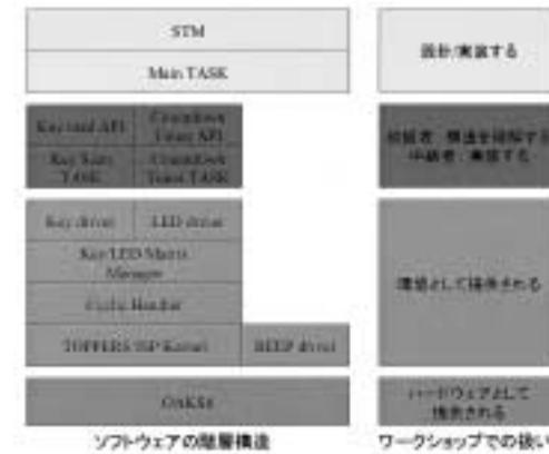
図1 ソフトウェアの階層構造と本ワークショップで実装する部分
