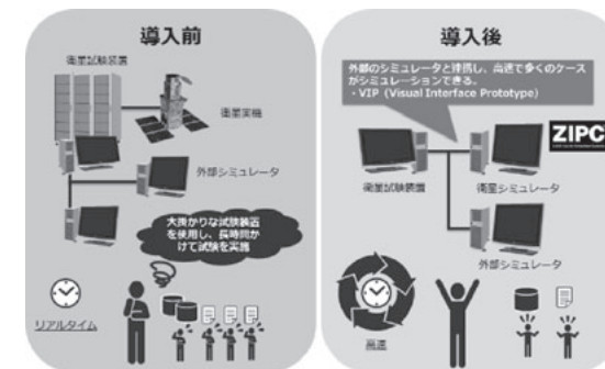
図5-3 外部シミュレータ連携および高速シミュレーションの実現
